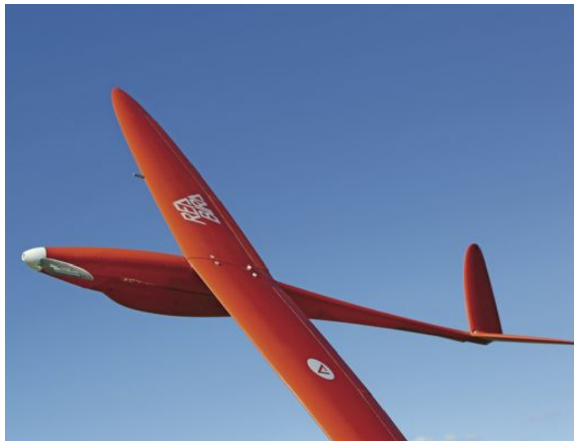
Un mini-drone (moins de 25 kg) en forme d'avion, dit « ailes volantes ». Il existe un autre type de mini-drone, en forme d'hélicoptère à plusieurs rotors.
