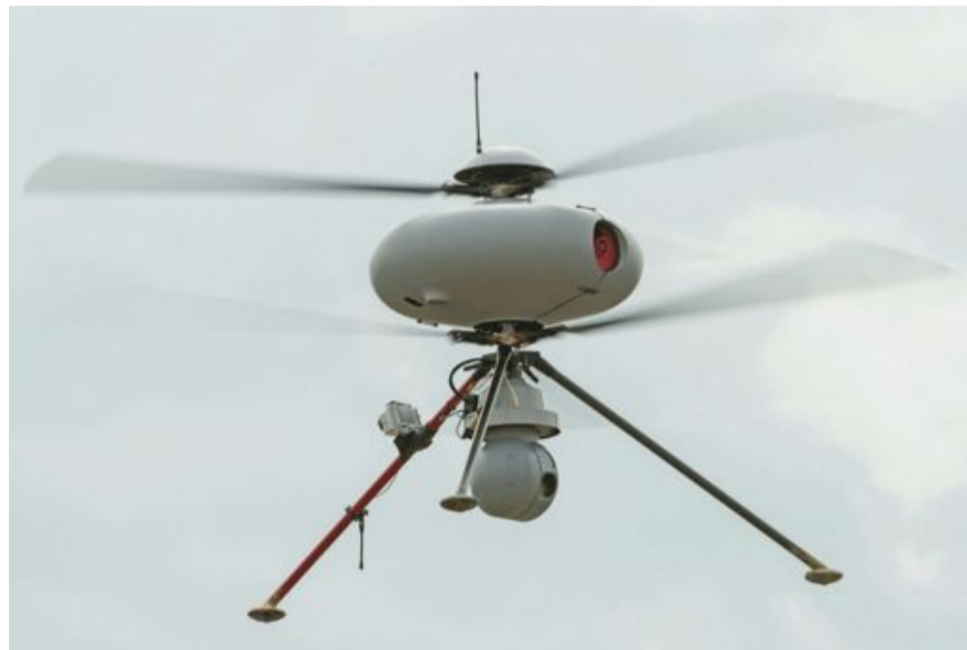
Le drone hélicoptère d'Infotron intéresse le secteur nucléaire pour les interventions en cas d'accident. © INFOTRON
