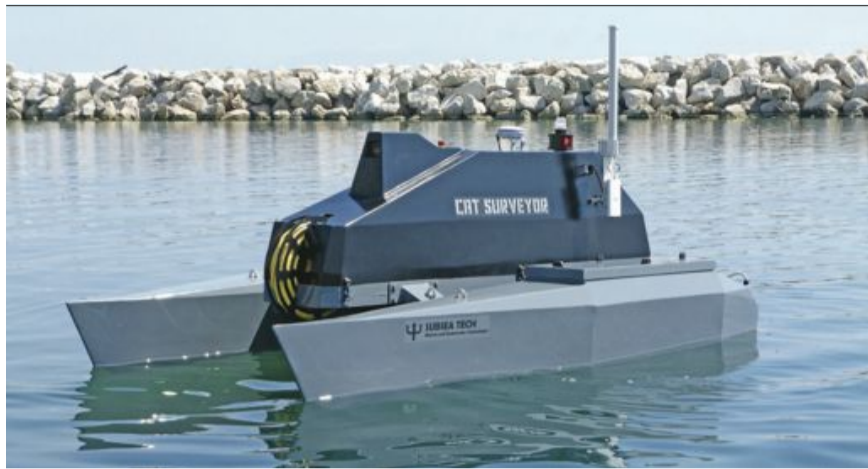
Le catamaran de surveillance de Subsea Tech, financé à 60% par la DGA, est piloté à distance par un opérateur à terre. © SUBSEA TECH
